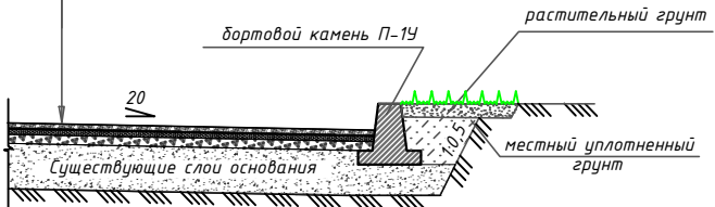
КОНСТРУКЦИЯ ПОКРЫТИЯ ОТМОСТОК Туп IIIб
